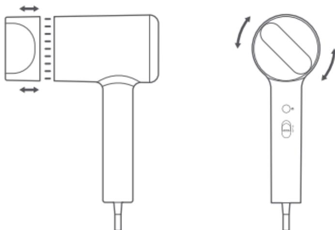
4 يُرجى إيقاف تشغيل مجفف الشعر قبل تركيب فوهة الهواء. لتجنب الحروق، لا تقم بتعديل فوهة الهواء أو تجميعها أو تفكيكها أثناء الاستخدام.
